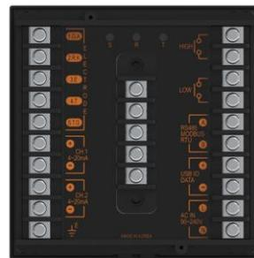
상기 설치가 완료 되면 계기 뒷면의 단자대에 입출력 단자대의 표기에 따라 좌측 센서케이블, CH1,CH2 전류 출력, 접지와 우측의 알람 접점, RS-485통신, AC전원 라인을 결선한다.
